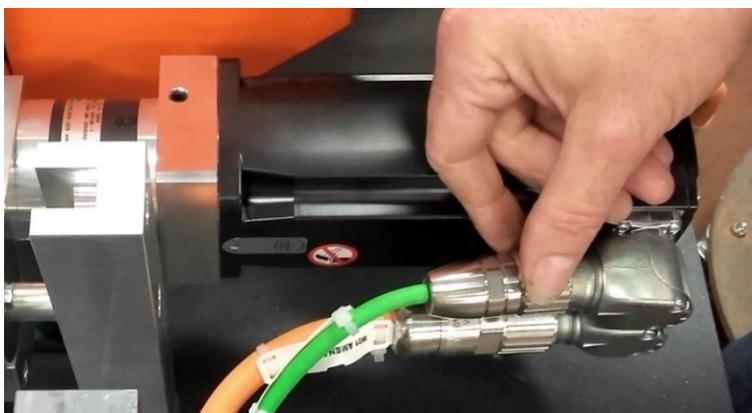
*Figura 16 - Scollegamento dei cavi del motore*
