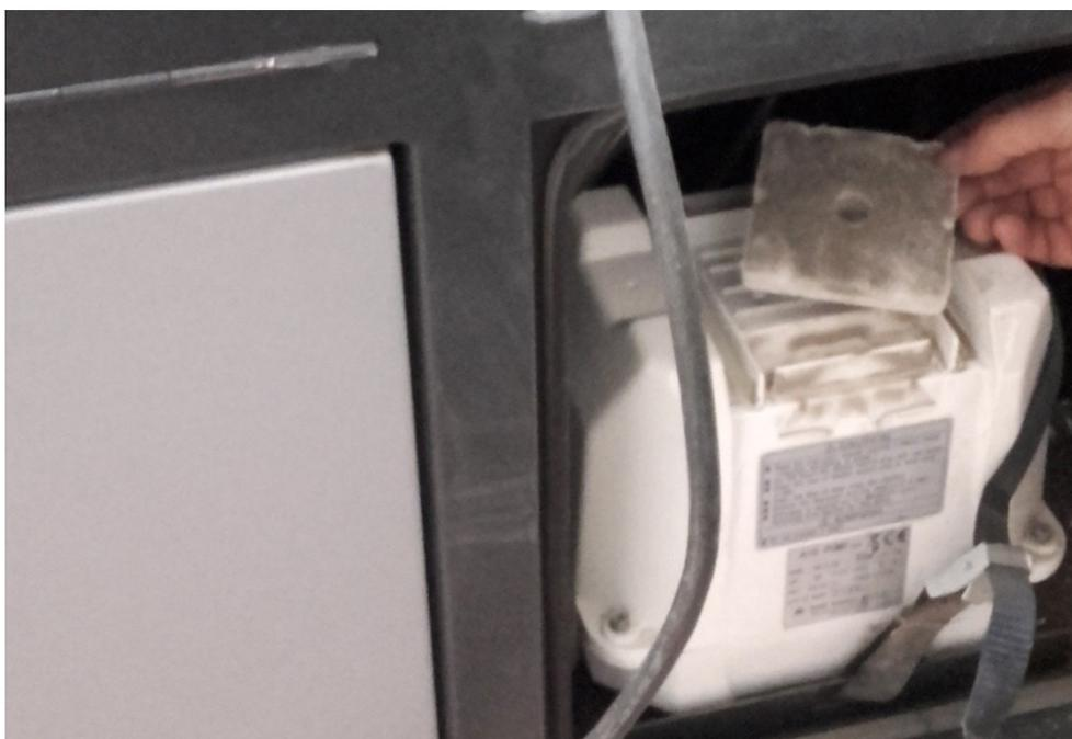
*Figura 7 - Accesso ai filtri compressore*
