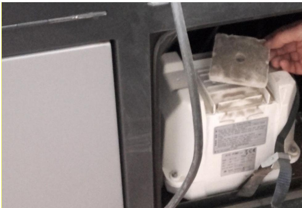
Figure 7 - Accès aux filtres compresseur
