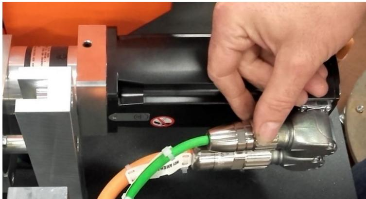
Figure 16 - Débranchement des câbles moteur
