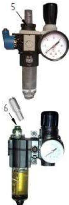
Modelo 1: levante el anillo negro (5) y gire en el sentido horario para aumentar el caudal de las gotas, en el sentido antihorario para reducirlo, después baje el anillo para bloquear el ajuste. El ajuste dispone de 7 vueltas y 6 muescas por vuelta.
